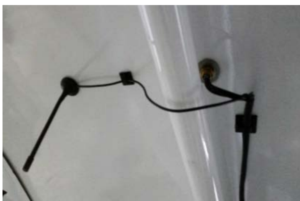
Bild 14: Montage WIFI-Antenne Dach-innenseite
