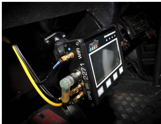
Bild 3: Standardinstallation Gerät+Antenne in klarer / ungehinderter Sicht
